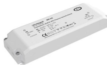
Der kurzschlussfeste Sicherheitstransformator kann problemlos beim Möbelbau zum Einsatz gebracht werden, da die MM-Kennzeichnung gegeben ist. Der Anschluss primärseitig und sekundärseitig erfolgt durch Schraubklemmen, welche für Kabel von 0,75mm<sup>2</sup> - 2,5mm<sup>2</sup> geeignet sind. Technische Daten: Versorgungsspannung: 220-240V/AC, ta: -20°C - 45°C, tc: 80°C, Powerfaktor 0,95.
