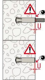
5.: Die Verspreizung ist ausreichend, wenn die Farbmarkierung auf dem Gewinde des Konusbolzens sichtbar ist oder der Unterstand U zwischen Konusbolzen mit Innengewinde und Sprezhülse eingehalten ist (FZA I). Bei Verwendung des FZA 12x40 ST R ist die Rändelung auf der Hülse bündig bzw. unterhalb der Betonoberfläche.
