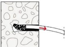
3.: Bohrloch reinigen.
