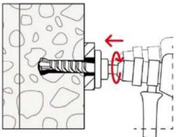
2.: Nach dem Anliegen des Tiefenanschlages des FZUB am Anbauteil wird durch kreisförmige Schwenkbewegungen der Hammerbohrmaschine mit eingeschaltetem Schlagwerk die Bohrlochhinterschneidung hergestellt. Dabei die Hammerbohrmaschine fest gegen das Anbauteil und den Verankerungsgrund drücken: 1-2 Schwenkbewegungen sind ausreichend für  $\varnothing 14$  mm, 3-5 Bewegungen für  $\varnothing 18$  mm und  $\varnothing 22$  mm.
