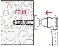
1.: Das Bohrloch ist rechtwinklig ( $\pm 5^\circ$ ) zur Oberfläche des Verankerungsgrundes mit einer Hammerbohrmaschine unter Verwendung des zugehörigen ZYKON-Universalbohrers FZUB herzustellen. Die erforderliche Bohrtiefe ist erreicht, wenn der Tiefenanschlag des FZUB am Beton anliegt.
