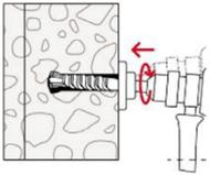
2.: Nach dem Anliegen des Tiefenanschlages des FZUB am Beton wird durch kreisförmige Schwenkbewegungen der Hammerbohrmaschine mit eingeschaltetem Schlagwerk die Bohrlochhinterschneidung hergestellt. Dabei die Hammerbohrmaschine fest gegen den Verankerungsgrund drücken: 1-2 Schwenkbewegungen sind ausreichend für  $\varnothing 14$  mm, 3-5 Bewegungen für  $\varnothing 18$  mm und  $\varnothing 22$  mm.
