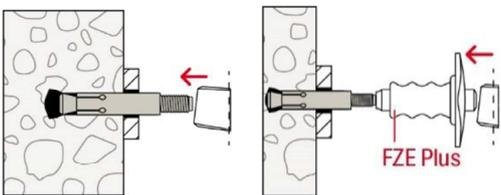
4.: Nach dem Einsetzen des Dübels durch das Anbauteil (z.B. Ankerplatte) in das Bohrloch ist die Sprezhülse mit dem Einschlaggerät FZE Plus einzuschlagen, Verwendung eines Handhammers.
