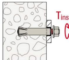
6.: Montagegegenstand (z.B. Ankerplatte), Unterlegscheibe und Mutter anbringen und Montagedrehmoment mit Drehmomentschlüssel aufbringen.
