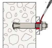
**Optional:** Der Ringspalt zwischen Bolzen und Anbauteil darf mit Mörtel verfüllt sein (Druckfestigkeit  $\geq 50$  N/mm<sup>2</sup> z.B. FIS SB) nach Schritt 6 (zur Minimierung des Lochspiels). Die Verfüllscheibe FFD ist zusätzlich zur Standard-Unterlegscheibe einzusetzen. Die Dicke der Verfüllscheibe muss bei  $t_{fix}$  berücksichtigt werden. Senkung in der Verfüllscheibe zeigt in Richtung des Anbauteils
