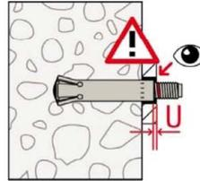
5.: Die Verspreizung ist ausreichend, wenn die Farbmarkierung auf dem Gewinde des Konusbolzens sichtbar ist.
