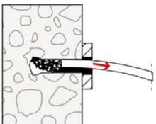
3.: Bohrloch reinigen.
