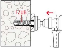
1.: Das Bohrloch ist rechtwinklig ( $\pm 5^\circ$ ) zur Oberfläche des Verankerungsgrundes durch das Durchgangsloch im Anbauteil mit einer Hammerbohrmaschine unter Verwendung des zugehörigen ZYKON-Universalbohrers FZUB herzustellen. Die erforderliche Bohrtiefe ist erreicht, wenn der Tiefenanschlag des FZUB am Anbauteil anliegt.
