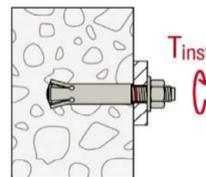
6.: Montagegegenstand (z.B. Ankerplatte), Unterlegscheibe und Mutter bzw. Schraube (für FZA I) oder Gewindestange mit Unterlegscheibe und Mutter (für FZA-I) anbringen und Montagedrehmoment mit Drehmomentschlüssel aufbringen.
