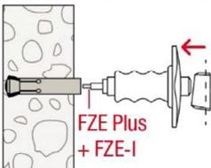
4.: Nach dem Einsetzen des Dübels in das Bohrloch ist die Sprezhülse mit dem Zentrierstift und Einschlaggerät FZE Plus und einzuschlagen, Verwendung eines Handhammers.
