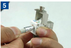
5 Modul anhand des Farb- codes in Keystonebuchse einsetzen
