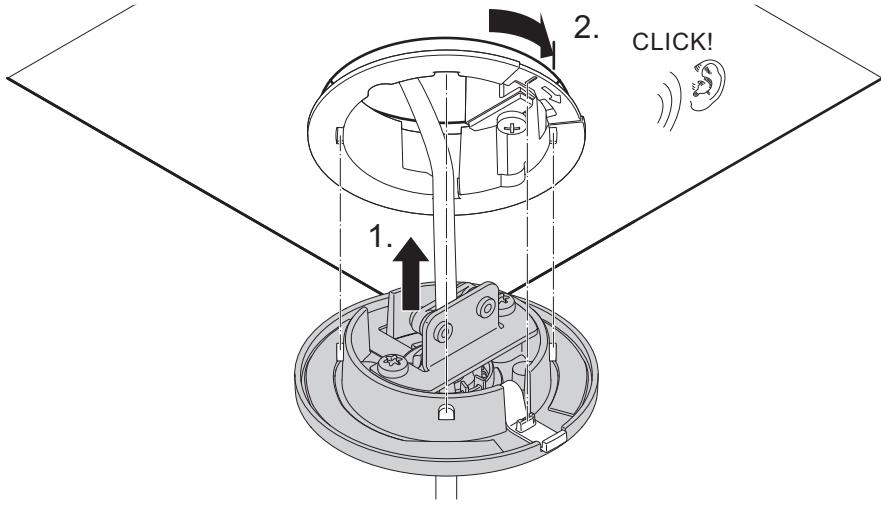
Dismantling - Demontage - Démontage - Smontaggio - Desmontaje- Demontage
