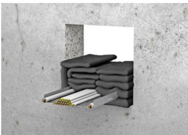
4. Bei einer Deckenstärke < 250 mm muss die Decke mittels nichtbrennbaren Bauplatten auf die erforderliche Mindeststärke von 250 mm aufgedoppelt werden. Zur Fixierung der Brandschutzkissen in der Bauteilöffnung dient ein deckenunterseitig angebrachtes Stahlgitter ( $\leq 40 \times 40 \times 4,0$  mm, nicht im Lieferumfang enthalten), auf das ein Glasgewebe ( $\geq 125$  g / m<sup>2</sup>) gelegt wird
