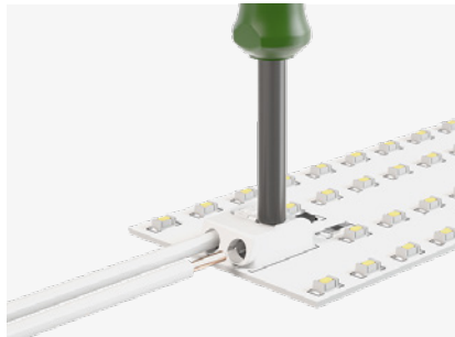
Feindrängige Leiter anschließen und Leiter lösen – durch geringen Druck auf den Drücker, z.B. mit Betätigungswerkzeug (Bestellnr. 206-860).
