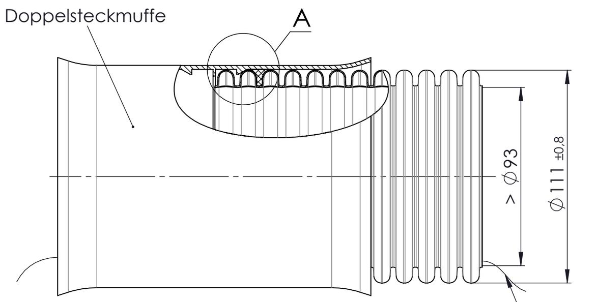
optional mit Profildichtring montiert im 2. Wellental
