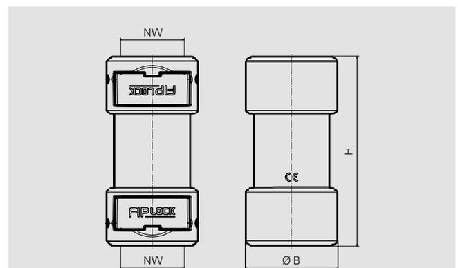
**Montagehinweis:** Wellrohr mit leichter Drehbewegung bis zum Anschlag in die Verschraubung einstoßen. Durch anschließend leichtes Zurückziehen wird die Verriegelung optimal positioniert. Wir empfehlen das Wellrohr im Wellental zu schneiden, um so den bestmöglichen Schutz zu gewährleisten.
