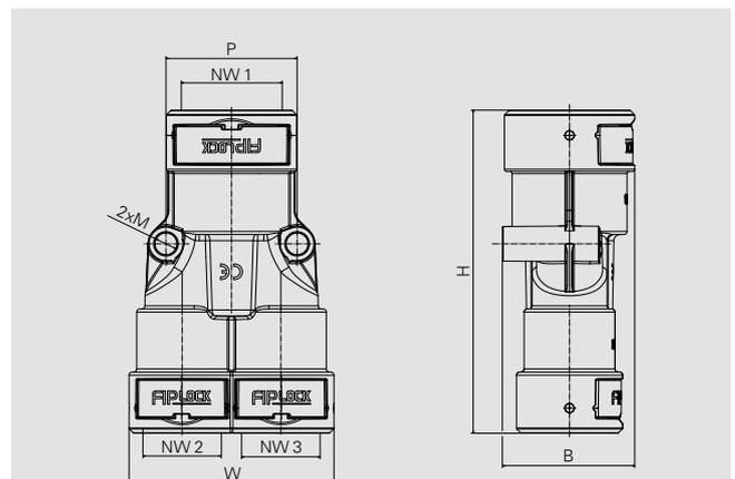
**Montagehinweis:** Wellrohr mit leichter Drehbewegung bis zum Anschlag in die Verschraubung einstoßen. Durch anschließend leichtes Zurückziehen wird die Verriegelung optimal positioniert. Wir empfehlen das Wellrohr im Wellental zu schneiden, um so den bestmöglichen Schutz zu gewährleisten.
