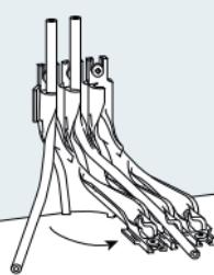
Das FFKu-Fibre net kann in den bereits montierten Fibre net IB nachträglich eingelegt, bzw. wieder herausgenommen werden.
