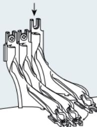
Sollen mehrere FFKu-Fibre net umgelenkt werden, können beliebig viele Fibre net IB aneinander gestapelt werden. Die folgenden Fibre net IB von oben in die Verriegelung des bereits montierten Fibre net IB einschieben und an der Unterseite miteinander verriegeln. Die Verriegelung am Fibre net IB ist wiederlösbar.
