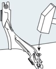
Den Fibre net IB an Wand und Boden befestigen.
