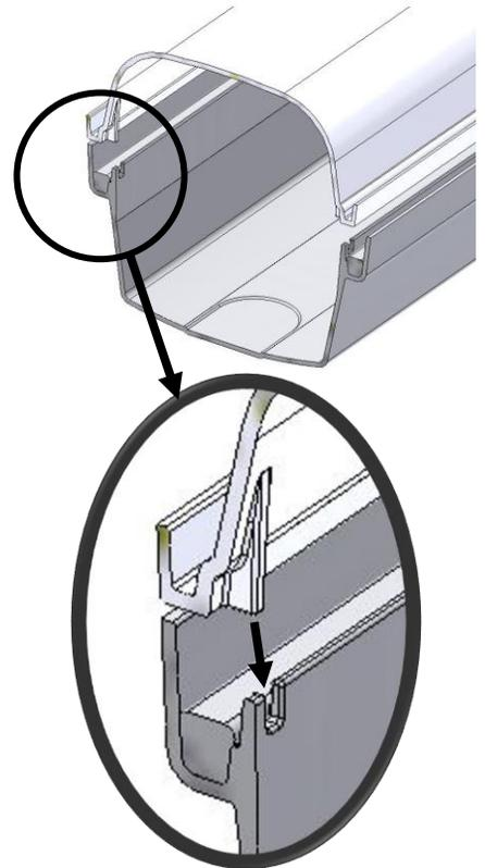
Steg der Leuchtenwanne muss in die Nut des Gehäuses eingeschoben werden (s. Abbildung).
