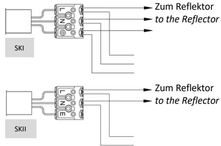
Durchgangsverdrahtung 5 polig
