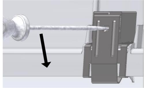
Je nach Ausführung der Leuchte ist das Gehäuse mit einer unterschiedlichen Anzahl von Sicherheitsverschlüssen versehen. Diese sind mit einem Schlitzschraubendreher mit 4 mm Klingenbreite gemäß obiger Anleitung zu öffnen und zu schließen.
