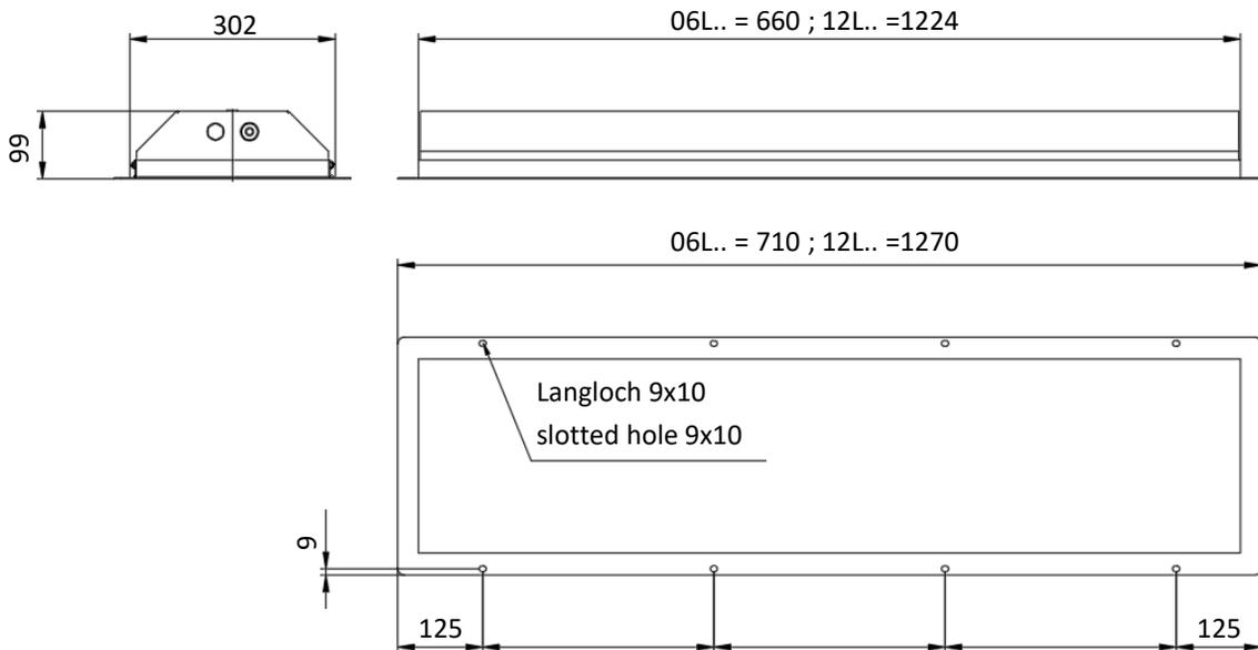
Achtung: Beim Einbau in gedämmten Decken- und Wandausschnitten reduziert sich die maximale Umgebungstemperatur (Tmax) der Leuchte um 5°C!
