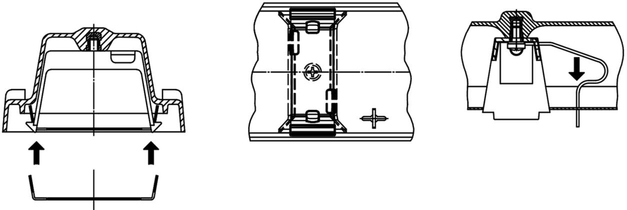
Montage Schnellsteckverbindung FastConnect ( FC )
