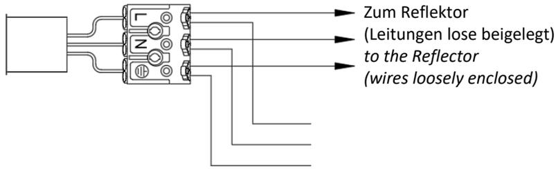
Durchgangsverdrahtung 5 polig
