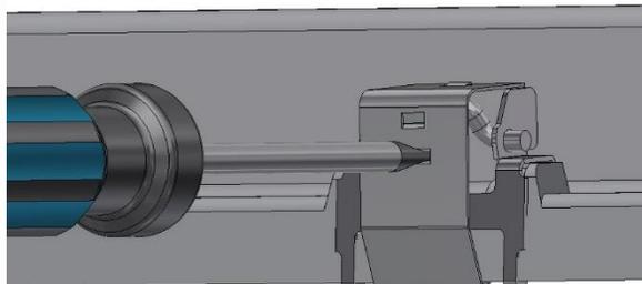
Je nach Ausführung der Leuchte ist das Gehäuse mit einer unterschiedlichen Anzahl von Sicherheitsverschlüssen versehen. Diese sind mit einem Schlitzschraubendreher mit 4 mm Klingenbreite gemäß obiger Anleitung zu öffnen und zu schließen.
