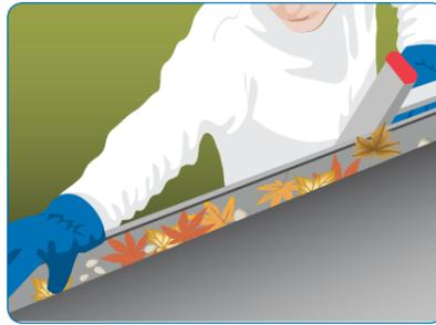
1) Überprüfen Sie das zu beheizende Dach und Ablaufrinnensystem und entfernen Sie alle scharfen Kanten, Blätter und Schmutz. Überprüfen Sie die Schalttafel und bereiten Sie diese vor.
