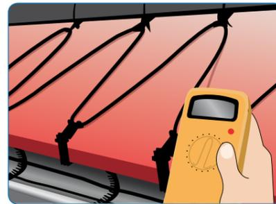
5) Installieren Sie das/die Kabel auf dem Dach, in den Ablaufrinnen und Fallrohren. Überprüfen Sie erneut den Isolationswiderstand und den Ohmwert für Kabel mit konstanter Wattzahl und vergleichen Sie diese.
