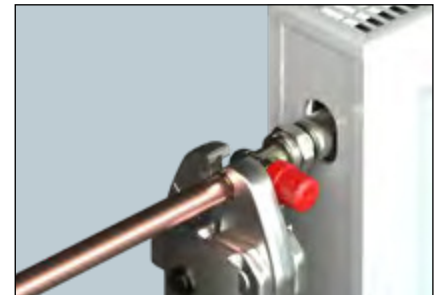
Achten Sie auf eine korrekte, mittige Platzierung des Ventils in der Pressbacke und verpressen Sie es. Verwenden Sie keine ölhaltigen Gleitmittel und achten Sie auf Sauberkeit innerhalb des Pressbereichs.
