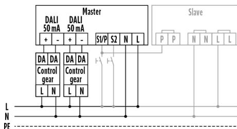
Standardbetrieb mit optionaler Ansteuerung durch Schlieftaster und Verwendung von max. 10 Slave-Geräten an einem Master-Gerät.
