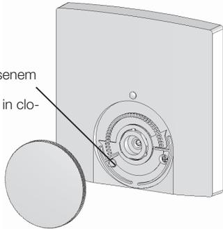
Lerntaste bei geöffnetem Gehäuse
