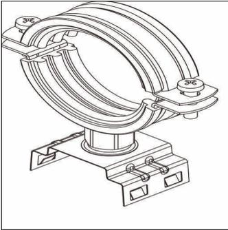
Monsun® 11/21, Rohrschellen-Befestigung, Montageart: Anbau, Montage-Set, bestehend aus je 2x Rohrschelle aus galvanisch verzinktem Stahl mit Gummieinlage, Zylinderkopf-Schraube, Befestigungsclip für Leuchte aus V2A sowie 2x Befestigungsverstärkung aus UV-stabiliertem PC, Klemmbereich: für Rohrdurchmesser 2", Verpackungseinheit: 1 Satz = 2 Stück
