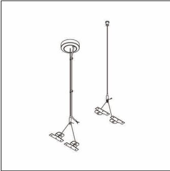
Apollon® 2, Y-Seilabhangung, Deckenhulse, mit mit 2 Klemmen, 1 polig, max. 2,5mm<sup>2</sup>, Anschlussleitung,2X0,75mm<sup>2</sup>, Deckenbefestigungselement, aus Stahl, verzinkt, Baldachin, aus Kunststoff, Seil, aus Stahl, verzinkt, leuchtenseitige Befestigung, aus Stahl, verzinkt, Deckenhulse, aus Stahl, vernickelt, Verpackungseinheit: 1 Satz = 2 Stuck
