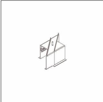
Silica®, Deckenmontage-Element, Montageart: Einbau, aus Aluminium/Eisen,
