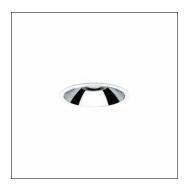
Lunis 21, L, Downlight, aus PC, Lichtaustritt: direkt strahlend, LED Bemessungslichtstrom: 1.670lm, Lichtfarbe: 830, Vorschaltgerät: EVG-DALI, mit Klemme, 5polig, Netzanschluss: 220..240V, AC, Gehäuse, rund, aus Aluminium-Druckguss, verkehrsweiß (RAL 9016), Durchmesser: 162mm, Schutzart (gesamt): IP20, Schutzart (raumseitig): IP54, Schutzklasse (gesamt): SK II (Schutzisoliert), Prüfzeichen: CE, Schlagfestigkeit: IK02, Verpackungseinheit: 1 Stück
