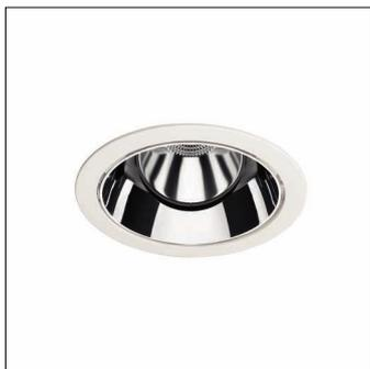
Lunis 11 mini round, Spot, Downlight, LED Bemessungslichtstrom: 1.110lm, Lichtfarbe: 840, mit Klemme, 5polig, Netzanschluss: 220..230V, AC, 50/60Hz, LED-Modul, Leuchtenmodul, aus Aluminium-Druckguss, lackiert, silber, Durchmesser: 176mm, Klemmbereich: 1..40mm, Einbauring, rund, aus PC, verkehrsweiß (RAL 9016), Schutzart (gesamt): IP20, Schutzklasse (gesamt): SK II (Schutzisoliert), Prüfzeichen: CE, zul. Umgebungstemperatur für Innenräume: 0..+35°C, Verpackungseinheit: 1 Stück
