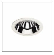
Lunis 11 mini round, Spot, Downlight, LED Bemessungslichtstrom: 2.760lm, Lichtfarbe: 840, mit Klemme, 5polig, Netzanschluss: 220...230V, AC, 50/60Hz, LED-Modul, Leuchtenmodul, aus Aluminium-Druckguss, lackiert, silber, Durchmesser: 176mm, Klemmbereich: 1..40mm, Einbauring, rund, aus PC, verkehrsweiß (RAL 9016), Schutzart (gesamt): IP20, Schutzklasse (gesamt): SK II (Schutzisoliert), Prüfzeichen: CE, zul. Umgebungstemperatur für Innenräume: 0...+35°C, Verpackungseinheit: 1 Stück
