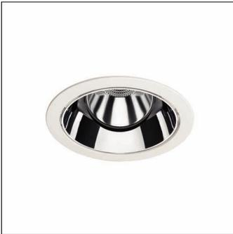
Lunis 11 mini round, Spot, Downlight, LED Bemessungslichtstrom: 3.240lm, Lichtfarbe: 840, mit Klemme, 5polig, Netzanschluss: 220..230V, AC, 50/60Hz, LED-Modul, Leuchtenmodul, aus Aluminium-Druckguss, lackiert, silber, Durchmesser: 176mm, Klemmbereich: 1..40mm, Einbauring, rund, aus PC, verkehrsweiß (RAL 9016), Schutzart (gesamt): IP20, Schutzklasse (gesamt): SK II (Schutzisoliert), Prüfzeichen: CE, zul. Umgebungstemperatur für Innenräume: 0..+35°C, Verpackungseinheit: 1 Stück
