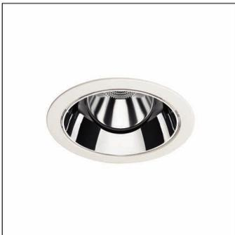
Lunis 11 mini round, Spot, Downlight, LED Bemessungslichtstrom: 2.780lm, Lichtfarbe: 830, mit Klemme, 5polig, Netzanschluss: 220..230V, AC, 50/60Hz, LED-Modul, Leuchtenmodul, aus Aluminium-Druckguss, lackiert, silber, Durchmesser: 176mm, Klemmbereich: 1..40mm, Einbauring, rund, aus PC, verkehrsweiß (RAL 9016), Schutzart (gesamt): IP20, Schutzklasse (gesamt): SK II (Schutzisoliert), Prüfzeichen: CE, zul. Umgebungstemperatur für Innenräume: 0..+35°C, Verpackungseinheit: 1 Stück
