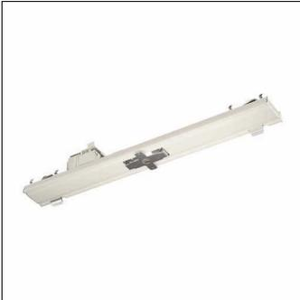
Licross®, Schieneneinsatz, Adapter, mit Stecker, 5polig, mit Phasenwahl, Netzanschluss: 230V, AC, 50/60Hz, Klemme, 5polig, max. 2,5mm<sup>2</sup>, Multi-Adapter, aus Stahlblech, bandlackiert, weiß, für Schutzart IP20/IP40, Länge: 500mm, Breite: 64mm, Höhe: 68mm, Multifunktionseinsatz, Schutzart (gesamt): IP20, Schutzklasse (gesamt): SK I (Schutzerdung), Prüfzeichen: CE, UKCA, Verpackungseinheit: 1 Stück
