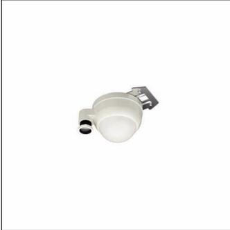
Highbay 11Sensor PE1, Slave, lokale Steuerung - autarke standalone Sensorik, zentrale Steuerung - Anbindung an Licht- oder Gebäudemanagement, dimmbar, Montageart: Anbau, Montageort: an der Leuchte, aus Kunststoff, Schutzart (gesamt): IP54, Prüfzeichen: CE, 1 x PIR-Bewegungssensor, 1 x Lichtsensor, 1 x DALI-2, 1 x Status-LED, Verpackungseinheit: 1 Stück
