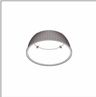
Highbay 42 S/L, Reflektor, primäre Lichtlenkung mit Reflektor, aus PC, klare Prismenstruktur, Lichtaustritt: direkt mit Deckenaufhellung strahlend, primäre Lichtcharakteristik: rotations-symmetrisch, Montageart: Anbau, Durchmesser: 410mm, Höhe: 141mm, Verpackungseinheit: 1 Stück
