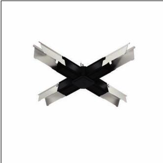
Licross®, X-Verbinder, Tragschienen-Element, aus Stahl, verzinkt, lackiert, tiefschwarz matt (RAL 9005), Länge: 300mm, Breite: 300mm, Höhe: 67mm, Blindabdeckung, aus PC/ABS, tiefschwarz (RAL 9005), Verbinder, aus Stahl, verzinkt, Schutzart (gesamt): für Schutzart IP20/IP40, Prüfzeichen: CE, UKCA, Verpackungseinheit: 1 Stück
