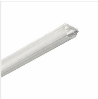
Zubehör Lichttechnik, für Monsun®, Abdeckwanne, aus PMMA, Prismenstruktur, innenliegend, für 1 x T16 | T26 28/36/54W, Länge: 1.271 mm, Breite: 84 mm
