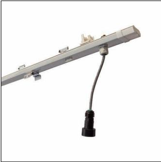
Monsun® 11 Extreme, Schieneneinsatz, Leuchten-Montage-Einsatz, mit Stecker, 6polig, mit Phasenwahl / Systemverbindung Leuchte: Buchse, 6+2polig, Netzanschluss: 220..240V, AC, 50..60Hz, Akku: NiMH, 4Ah, DC, Stirnwand, aus PC, weiß, Länge: 1.495mm, Breite: 48mm, Leuchten-Montage-Einsatz, aus Stahlblech, verzinkt, lackiert, leuchtenweiß, Schutzart (gesamt): IP64, Schutzklasse (gesamt): SK I (Schutzerdung), Schutzzeichen: D, zul. Betriebsumgebungstemperatur: +5..+40°C, Verpackungseinheit: 1 Stück
