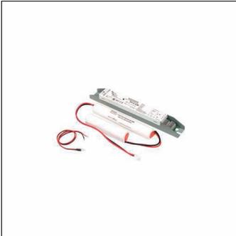
Zubehör Elektrik, für Systemzubehör, Vorschaltgerät: Notlicht-Element, Akku: NiMH, 3Ah, mit Klemme, 3polig, max. 2,5mm<sup>2</sup>, Netzanschluss: 230V, AC, 50Hz, Länge: 225mm, Breite: 30mm, Notlicht-Element, rechteckig, aus Stahlblech, Länge: 235mm, Breite: 30mm, Schutzart (gesamt): IP20, Prüfzeichen: CE, ENEC in Vorbereitung, zul. Umgebungstemperatur für Innenräume: -10..+25°C
