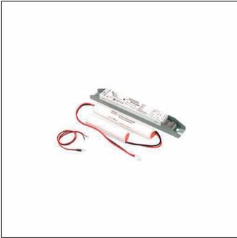
Zubehör Elektrik, für Systemzubehör, Vorschaltgerät: Notlicht-Element, Akku: NiCd, 7Ah, mit Klemme, 3polig, max. 2,5mm<sup>2</sup>, Netzanschluss: 230V, AC, 50Hz, Länge: 225mm, Breite: 30mm, Notlicht-Element, rechteckig, aus Stahlblech, Länge: 235mm, Breite: 30mm, Schutzart (gesamt): IP20, Prüfzeichen: CE, ENEC in Vorbereitung, zul. Umgebungstemperatur für Innenräume: -10..+25°C
