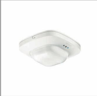
SITECO ConnectMultisensor, Master, lokale Steuerung, dimmbar, Montageart: Einbau, Montageort: in der Decke, aus Kunststoff, Schutzart (gesamt): IP20, Schutzklasse (gesamt): SK II (Schutzisoliert), Prüfzeichen: CE, VDE, Spannung: 220..240V, Spannungsart: AC, 1 x PIR-Bewegungssensor, 4 x Tastereingang, 1 x 1 x Lichtsensor, 1 x DALI, Verpackungseinheit: 1 Stück
