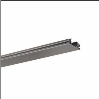
Vega® 11, Montageschiene, Montageart: abgehängte Montage, mit Klemme, 3+3polig, max. 2,5mm<sup>2</sup>, Schiene, aus Alu-Strangpreßprofil, eloxiert, natur, Länge: 4.000mm, Breite: 64mm, Höhe: 22mm, Schutzart (gesamt): IP20, Prüfzeichen: CE, Verpackungseinheit: 1 Stück
