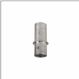
Reduzierstück, Montageart: Einsteckmontage, Reduzierhülse, aus St 37-2, verzinkt, Länge: 165mm, Durchmesser: 42mm, Zopfmaß: 60/42mm, Verpackungseinheit: 1 Stück
