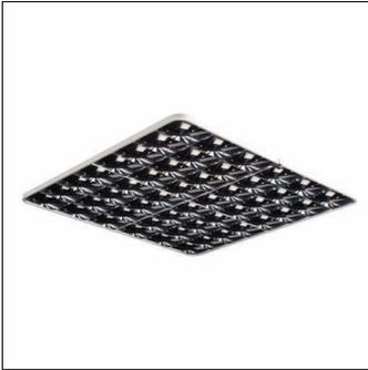
Spiegel-Werfer-Reflektor, für Siteco Mirrortec® Indoor, Seilabhänger, Gehäuse, quadratisch, aus Aluminium, lackiert, weißaluminium (RAL 9006), Fresnel Reflektor 100, aus PMMA, Alu bedampft, hochglänzend, Lichtpunkt-Zerlegung, Fresnelstruktur, Länge: 600 mm, Breite: 600 mm
