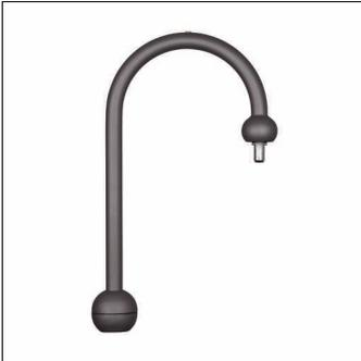
Große Glocke, Mastbogen, Mastbogen, fluchtend, aus Stahl, verzinkt, lackiert, Siteco® eisenglimmer (DB 702S), 1armig, mit Bajonettverschluss, Durchmesser: 89mm, Höhe: 1040mm, Zopfmaß: 76/89mm (Aufsatz), Verpackungseinheit: 1 Stück
