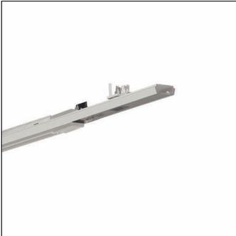
Modario®, Stromschieneneinsatz, mit Stecker, 5polig, mit Phasenwahl, für Tragschiene, 10adrig, Netzanschluss: 230/400V, Stromschienen-Einsatz, aus Stahlblech, bandlackiert, weißaluminium (RAL 9006), 2x Systemmaß, max. Gewichtsbelastung 5kg, Länge: 598mm, Breite: 48mm, Schutzart (gesamt): für Schutzart IP20, Schutzklasse (gesamt): SK I (Schutzerdung), Prüfzeichen: CE, Verpackungseinheit: 1 Stück
