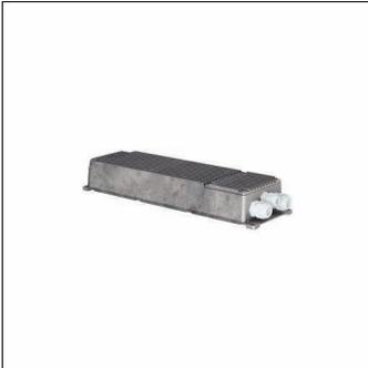
Floodlight FL 11 maxi pro EVG-Einheit; Helligkeitssteuerung: DMX+RDM; mit Klemme, 8polig, max. 2,5mm<sup>2</sup>, Netzanschluss: 220..240V/380..400V AC, Stoßspannungsfestigkeit: Line to Ground: 10kV, EVG-Einheit EVG-Einheit aus Aluminium-Druckguss, unbehandelt natur; Länge: 500mm / Breite: 152mm / Höhe: 77mm; Ausstattung: Longlife, Schutzklasse (gesamt): SK I (Schutzerdung); Prüfzeichen: CE; zul. Lagertemperatur: -40..+85°C; Verpackungseinheit: 1 Stück
