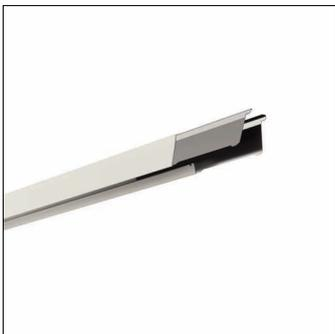
Licross®, Tragschiene, aus Stahlblech, verzinkt, bandlackiert, weiß, Länge: 1.500 mm, Breite: 64 mm, Höhe: 67mm, Durchverdrahtung: 11x 2,5mm<sup>2</sup>, Schutzart (gesamt): maximal IP64, abhängig von den verwendeten Einsätzen und Zubehören, Schutzklasse (gesamt): SK I (Schutzerdung), Prüfzeichen: CE, UKCA, LABS-Konformität geprüft gemäß VDMA 24364:2018-05, Verpackungseinheit: 1 Stück
