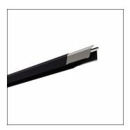
Licross®, Tragschiene, aus Stahlblech, verzinkt, bandlackiert, tiefschwarz matt (RAL 9005), Länge: 1.500 mm, Breite: 64 mm, Höhe: 67mm, Durchverdrahtung: 7x 2,5mm², Schutzart (gesamt): maximal IP64, abhängig von den verwendeten Einsätzen und Zubehören, Schutzklasse (gesamt): SK I (Schutzerdung), Prüfzeichen: CE, UKCA, LABS-Konformität geprüft gemäß VDMA 24364:2018-05, Verpackungseinheit: 1 Stück
