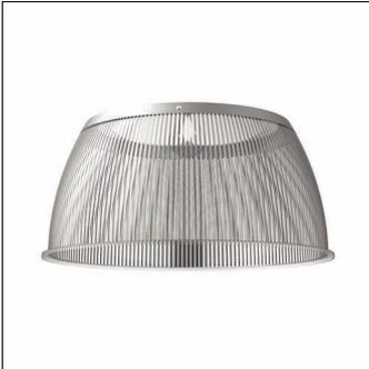
Highbay 31 S, Reflektor, primäre Lichtlenkung mit Reflektor, aus PC, klare Prismenstruktur, Lichtaustritt: direkt mit Deckenaufhellung strahlend, primäre Lichtcharakteristik: rotations-symmetrisch, Montageart: Anbau, Durchmesser: 480mm, Höhe: 227mm, Verpackungseinheit: 1 Stück
