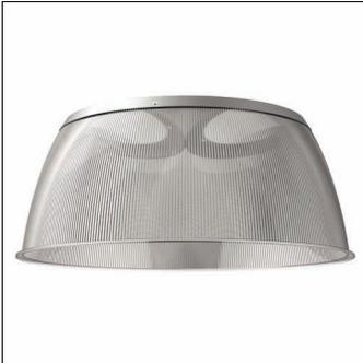
Highbay 31 L, Reflektor, primäre Lichtlenkung mit Reflektor, aus PC, klare Prismenstruktur, Lichtaustritt: direkt mit Deckenaufhellung strahlend, primäre Lichtcharakteristik: rotations-symmetrisch, Montageart: Anbau, Durchmesser: 570mm, Höhe: 234mm, Verpackungseinheit: 1 Stück
