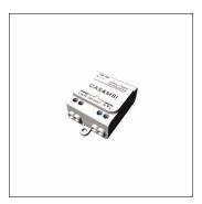
SITECO Connect WirelessController, Master, lokale Steuerung, dimmbar, Montageart: Einbau, Montageort: in der Leuchte, aus Kunststoff, Spannung: 230V, 1 x DALI, 1 x Bluetooth®-Schnittstelle, 1 x Schaltkontakt, Schutzart (gesamt): IP20, Schutzklasse (gesamt): SK II (Schutzisoliert), Prüfzeichen: CE, Verpackungseinheit: 1 Stück
