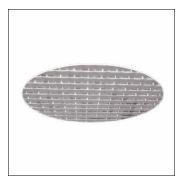
Spiegel-Werfer-Reflektor, für Siteco Mirrortec® Indoor, Kugelgelenk-Pendelabhängung, Gehäuse, kreisförmig, aus Aluminium, lackiert, weißaluminium (RAL 9006), Fresnel Reflektor 100, aus PMMA, Alu bedampft, hochglänzend, Lichtpunkt-Zerlegung, Fresnelstruktur, Durchmesser: 900 mm
