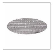
Spiegel-Werfer-Reflektor, für Siteco Mirrortec® Indoor, Seilabhänger, Gehäuse, kreisförmig, aus Aluminium, lackiert, weißaluminium (RAL 9006), Fresnel Reflektor 100, aus PMMA, Alu bedampft, hochglänzend, Lichtpunkt-Zerlegung, Fresnelstruktur, Durchmesser: 900 mm
