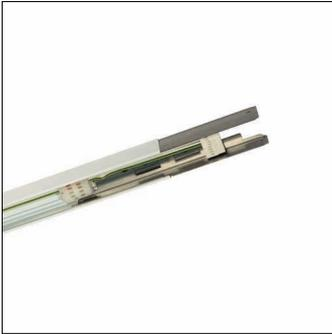
Modario®, Tragschiene, aus Stahlblech, lackiert, leuchtenweiß, 3längig, Länge: 4.485 mm, Breite: 58 mm, Höhe: 43mm, Durchverdrahtung: 5x 2,5mm<sup>2</sup>, mit Klemme, 5polig, max. 2,5mm<sup>2</sup>, Schutzart (gesamt): für Schutzart IP20/IP40, Schutzklasse (gesamt): SK I (Schutzerdung), Prüfzeichen: CE, ENEC, VDE, Norm: EN 60598, Verpackungseinheit: 1 Stück
