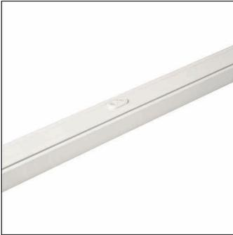
Modario®, zusätzliche Einspeisung, Verdrahtung, mit 20x Klemme 2-fach 1,5..2,5mm<sup>2</sup>, für Einspeisung, Durchverdrahtung: 10x 2,5mm<sup>2</sup>, Tragschienen-Element, aus Stahl, lackiert, leuchtenweiß, 4x Systemmaß, Länge: 1.196mm, Breite: 58mm, Höhe: 43mm, Schutzklasse (gesamt): SK I (Schutzerdung), Prüfzeichen: CE, UKCA, Verpackungseinheit: 1 Stück
